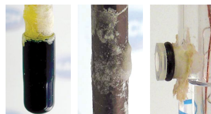
Obetydlig kristallisering på förvaringsbehållare, elektrodskaft eller påfyllningsöppning
